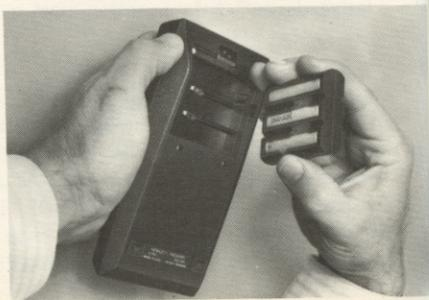
6. Batteriedeckel unter den unteren Rand des Gehäuses schieben.
