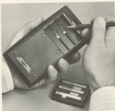
5. Batterie mit den vergoldeten Kontakten nach innen einsetzen.
